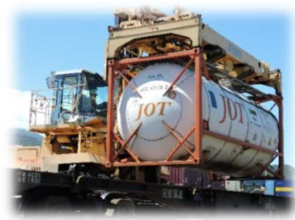
トップリフターによる荷役の様子
